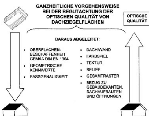
Schema: Gesamtstruktur Dachziegel/Dachfläche
