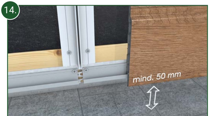
14. Die Montage der Fassadenprofile beginnt am unteren Fassadenrand, indem das erste Fassadenprofil gemäß Skizze in das Aluminium-Startprofil eingehängt wird. Bitte beachten Sie den Mindestabstand Unterkante Fassadenprofil von 50 mm zum Bodenniveau.
