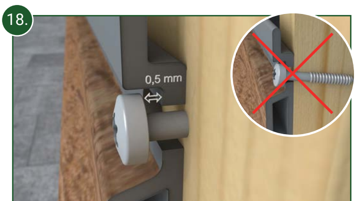
18. ACHTUNG: Die Fassadenschrauben dürfen nur so fest eingedreht werden, dass sich das Fassadenprofil nach der Verschraubung noch schieben lässt! Zudem dürfen die Schrauben nicht schräg eingebracht werden.
